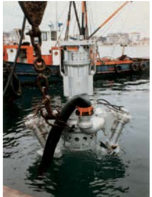
Rimozione deposito di limo in porto turistico Removing silt deposits from a harbour
